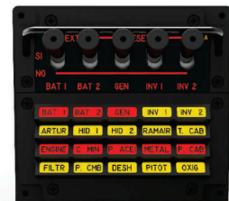
Panel de Alarmas Piloto
